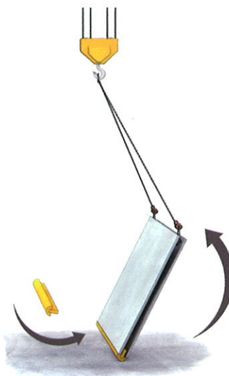
Figure 20. Relevage avec un sabot
