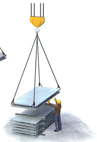
Figure 15. Utilisation de quatre crochets de levage
