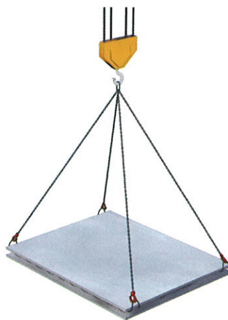
Figure 14. Élingage des petits éléments
