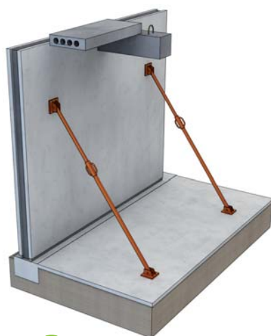
PRÉMUR BÉTONNÉ POUTRE CLAVETÉE
