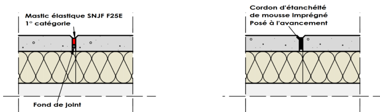
Figure 70 : Traitement du joint INTERIEUR entre (i)Premur A2C
